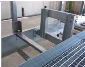
Halterungen für den Förderer, Feuerverzinkt mit Höhenverstellbarkeit.
