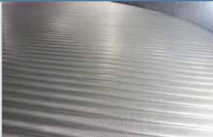
Consiste em um piso totalmente perfurado e apoiado em uma estrutura galvanizada. As perfurações têm diâmetro de 1 ou 1,5 mm, dependendo do material armazenado. Os suportes são feitos de aço galvanizado quente, permitindo melhor fluxo de ar e, portanto, melhor ventilação.
