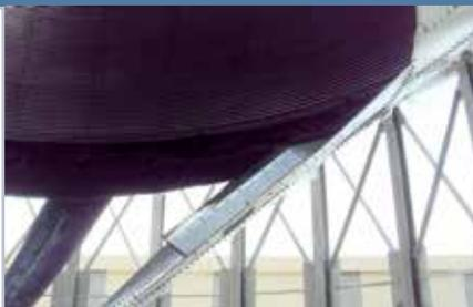
Sistema constituído por um canal de aeração com perfurações, fixado a um setor de tremonha preparada para a conexão do ventilador.
