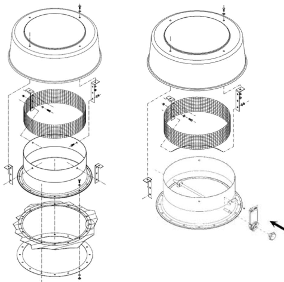
Chimenea de ventilación en techo y chimenea para fumigación. Accesorios. Sistemas de ventilación
