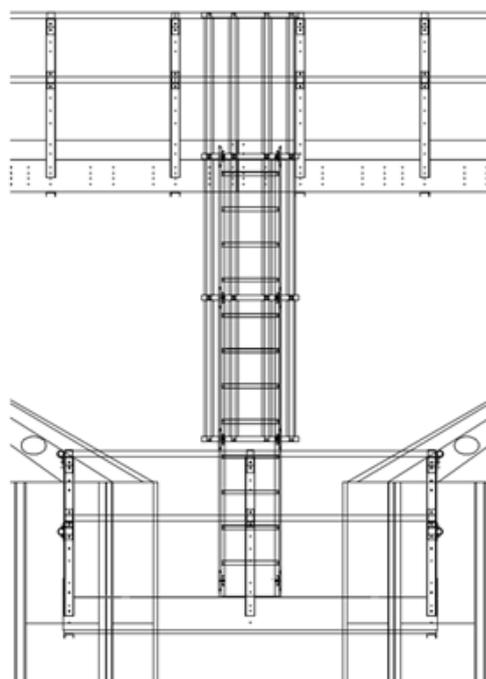
Plateforme entre silos et escalier.
