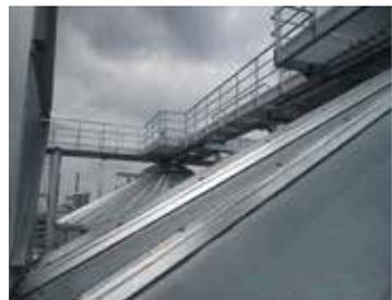
Estructuras metálicas modulares de 700, 900 o 1100 mm. de anchura que se adaptan a la instalación para facilitar el mantenimiento. Posibilidad de suelo standard y tramex.
