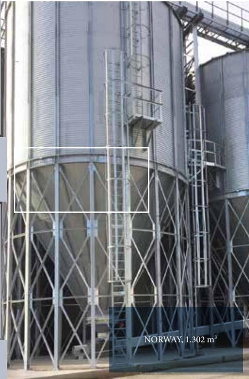
La tolva está formada por sectores de **acero estructural S 350 GD-Z600**, y puede realizarse con un **ángulo de 45°, 60° ó 66°**, dependiendo del flujo del material almacenado.
