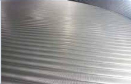
Consiste en un suelo totalmente perforado, y soportado sobre una estructura galvanizada. Las perforaciones tienen un diámetro de 1 ó 1,5 mm, dependiendo del material almacenado. Los soportes están fabricados en acero galvanizado en caliente, permitiendo un mejor flujo del aire, y por lo tanto, una mejor ventilación.
